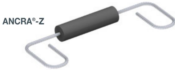
ANCRA®-Z Zuganker zur Übertragung von Zugkräften. Durch den Schaumstoffmantel können Querbewegungen aufgenommen werden. Projektbezogene Formen und Abmessungen können gerne gefertigt werden.
