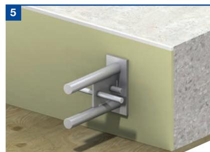
Drücken Sie nun den Dornenteil durch das Fugenfüllmaterial bis zum Anschlag in die eingebaute Hülse. Um zu verhindern, dass es zu Verschiebungen des Dornenteils beim Betonieren kommt, ist die Hülse mit einer kleinen Quetschung ausgestattet, die den Dornenteil im Einbauzustand fixiert. Um diese Quetschung beim Einbringen des Dornenteils zu überwinden, kann leichtes Klopfen erforderlich sein.
