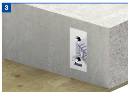
Nachdem der Beton eine ausreichende Festigkeit erreicht hat kann die Schalung entfernt werden. Nun kann der Aufkleber auf dem eingebauten Hülsesteil entfernt oder durchstochen, und der Dorn eingebracht werden. **Wichtig:** Bei der Verwendung von querbeweglichen Dornen (DSDQ) sollte der Aufkleber immer mittig durchstochen werden, sodass nur der zylindrische Hülsesteil, der mittig in der Rechteckhülse sitzt, für den Dornenteil frei wird und der restliche Teil der Hülse geschützt bleibt.
