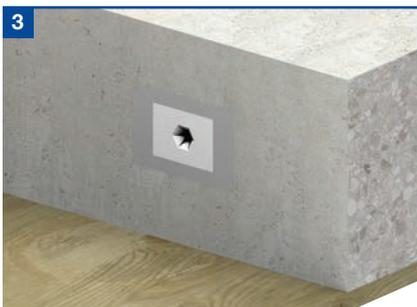
Nachdem der Beton eine ausreichende Festigkeit erreicht hat kann die Schalung entfernt werden. Nun kann der Aufkleber auf dem eingebauten Hülse entfernt oder durchstochen, und der Dorn eingebracht werden. **Wichtig:** Bei der Verwendung von querbeweglichen Dornen (HLDQ oder ESDQ) sollte der Aufkleber immer mittig durchstochen werden, sodass nur der zylindrische Hülse teil, der mittig in der Rechteckhülse sitzt, für den Dorn teil frei wird und der restliche Teil der Hülse geschützt bleibt.
