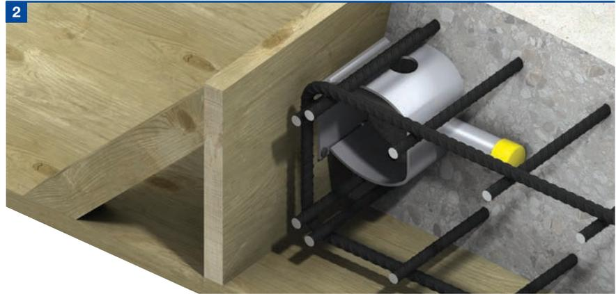
Nach dem Verlegen der erforderlichen Bewehrung und einer letzten Kontrolle, ob ausreichend Bewehrung und Betondeckung vorhanden ist, kann der Beton in die Schalung eingebracht werden. Somit ist der Einbau des Hülse teiles komplett.
