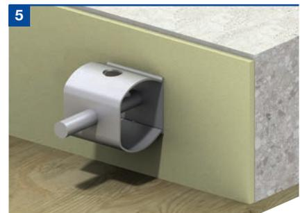
Drücken Sie nun den Dorn teil durch das Fugenfüllmaterial bis zum Anschlag in die eingebaute Hülse. Um zu verhindern, dass es zu Verschiebungen des Dorn teiles beim Betonieren kommt, ist die Hülse mit einer kleinen Quetschung ausgestattet, die den Dorn teil im Einbauzustand fixiert. Um diese Quetschung beim Einbringen des Dorn teiles zu überwinden, kann leichtes Klopfen erforderlich sein.
