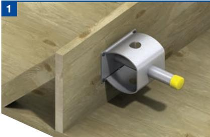
Der Hülse wird mit Nägeln, entsprechend der Lastrichtung ausgerichtet, an der Schalung befestigt. Überprüfen Sie ob die minimalen Rand- und Achsabstände eingehalten wurden. Der Aufkleber schützt den Hülse vor dem Eindringen von Beton oder Zementmilch und sollte zu diesem Zeitpunkt nicht beschädigt werden.
