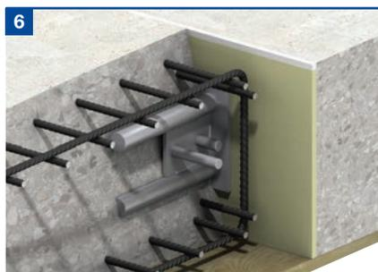
Nun kann die Bewehrung um den Dorn gelegt werden, wobei wiederum auf die Bewehrungsdimensionen und die erforderliche Betonüberdeckung geachtet werden muss. Der Einbau wird durch das Einbringen des Betons abgeschlossen.
